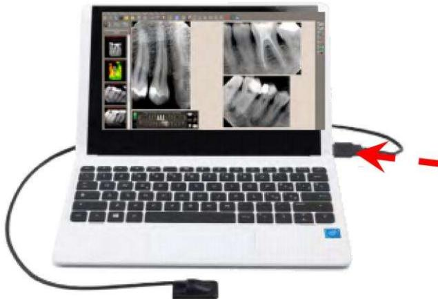
Připojte senzor k USB® portu počítače (senzor stand-alone)
