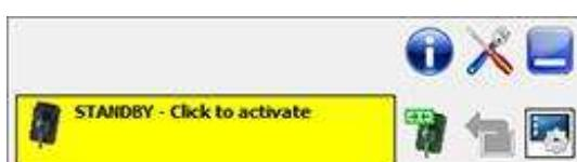
Signál **žluté** barvy označuje situaci stand-by. Před pořízením rentgenového snímku je nutné opět zaktivovat senzor, například kliknutím na žlutý rámeček na obrazovce nebo vyjmout senzoru z příslušného držáku.
