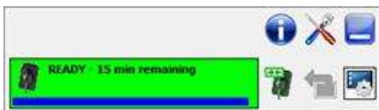
Rámeček **zelené** barvy označuje, že senzor je aktivní a připravený k pořízení rentgenového snímku. Poříďte snímek pouze, je-li senzor v tomto stavu.
